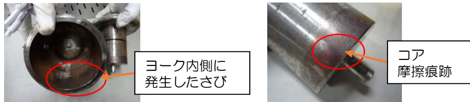
図 隣接機ソレノイド内部のさび
